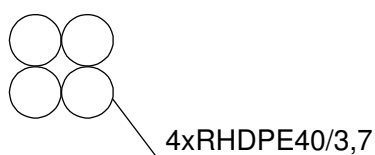
Rys.3.9. Wiazka rur RS ziemnych przyłącza PS3
